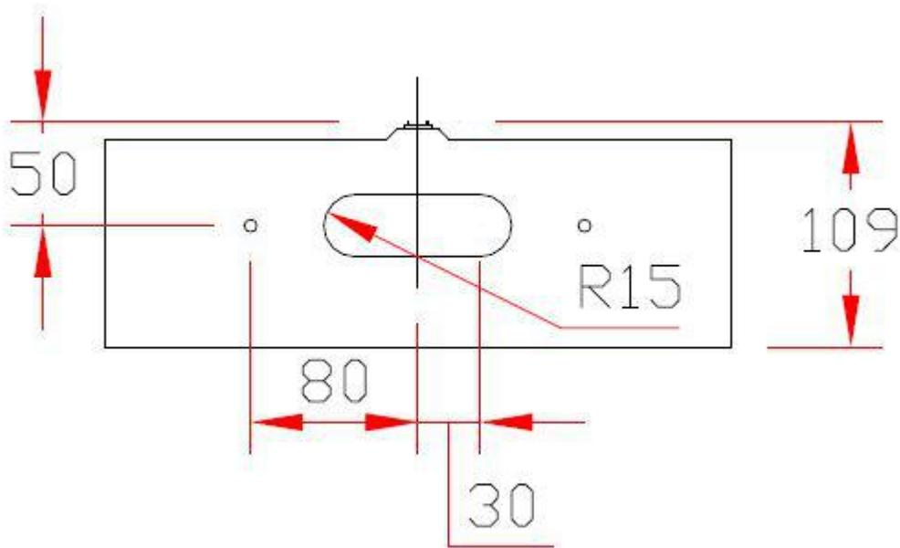
Die Bohrungen sind 50mm unter der Schienenoberkante zu setzen. Die Schraubenlöcher sind mit 8mm zu bohren. Die Module werden dann mit M6 Schrauben verbunden.
